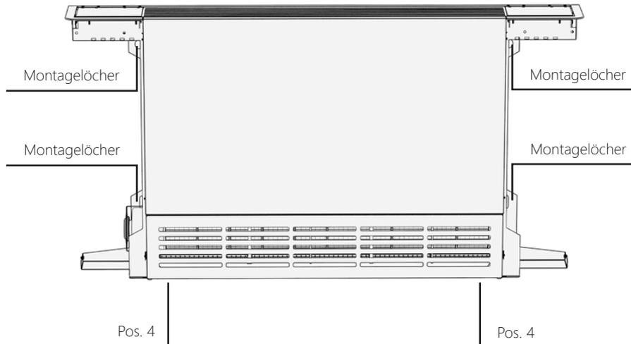
Wenn die Montage an einer Wand erfolgt, entfernen Sie die Füße (Pos. 4) und montieren Sie den Wärmepumpenheizkörper mithilfe der angegebenen Montagelöcher an der Wand
